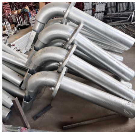
Hot galvanized parts 镀锌件
