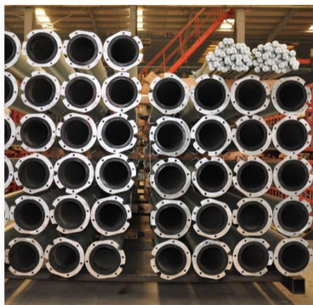
Poly-lined pipe 内衬管
